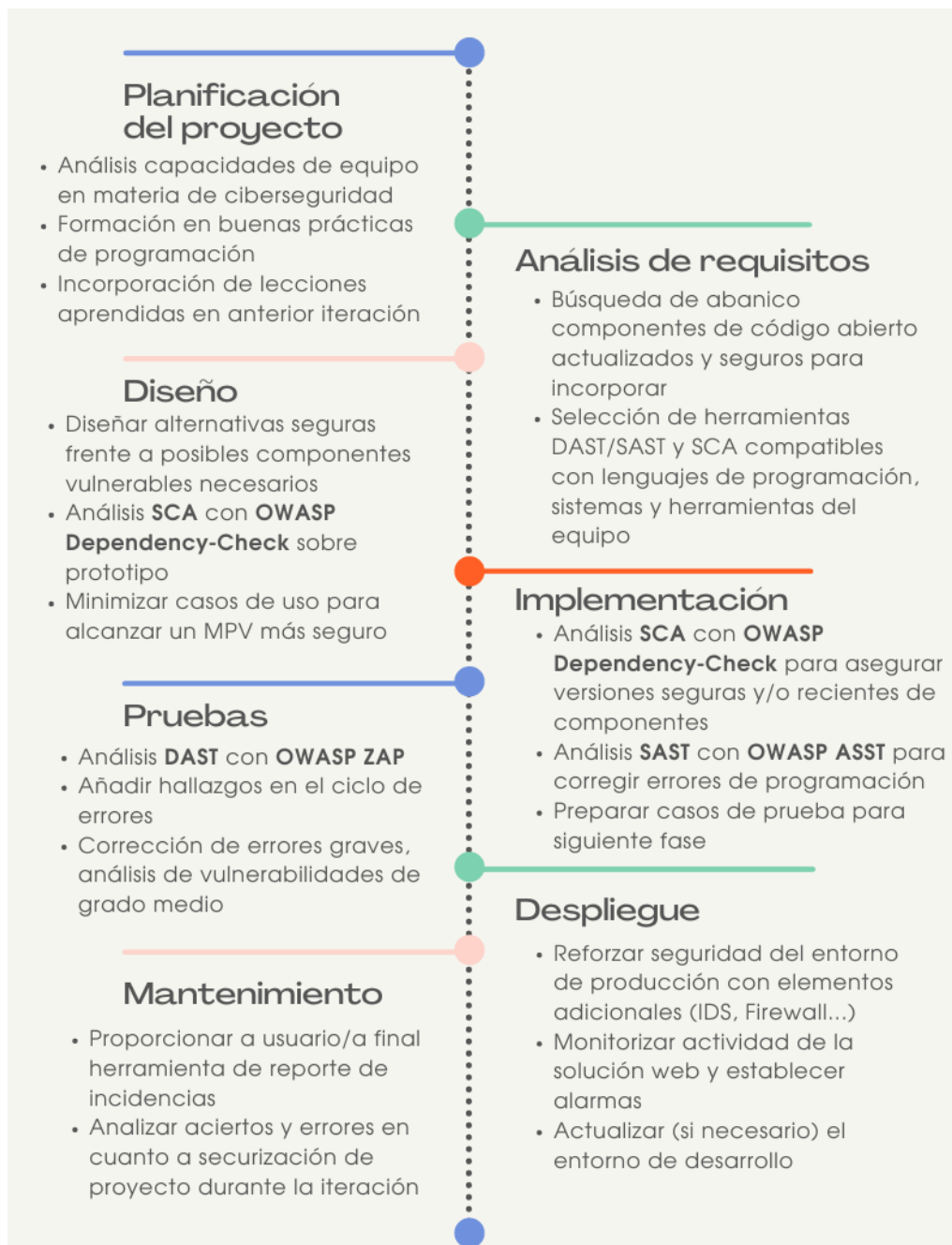
Ilustración 30: Esquema de todo el ciclo de vida integrando soluciones para securizarla
