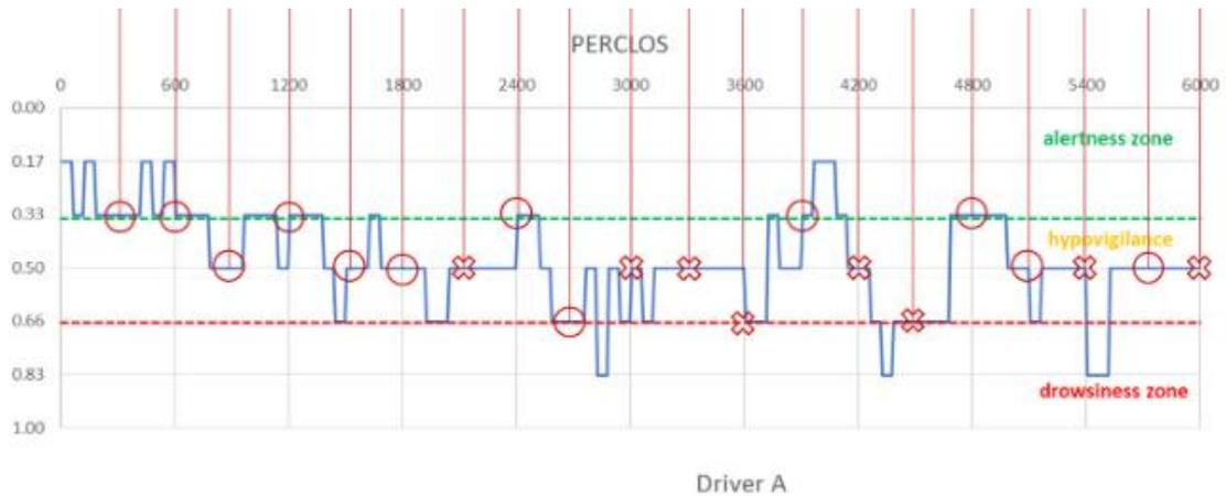
Figura 35. Umbral de fatiga determinado en [31]
