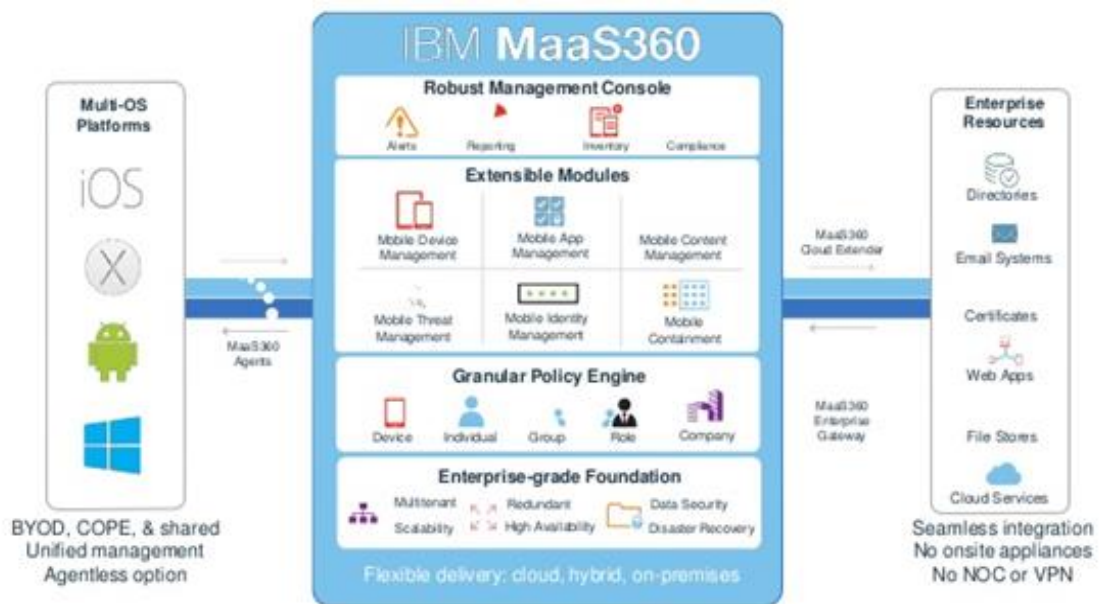
Il·lustració 12. Arquitectura IBM MaaS360 (font: IBM)
