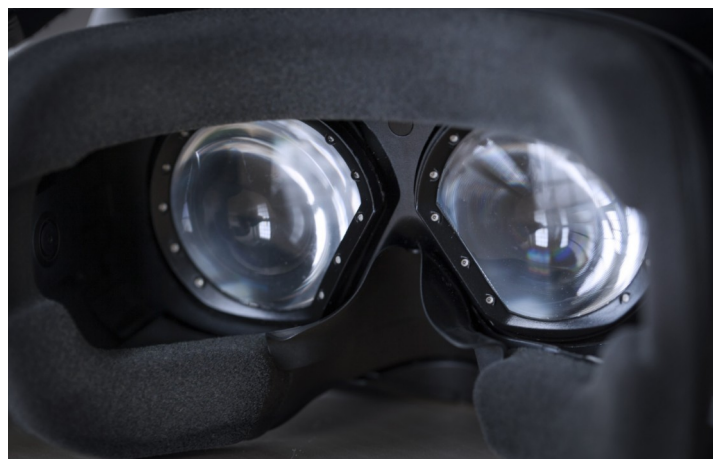
Figura 27: Tobii HTC Vive DevKit - Detalle sensores de seguimiento pupilar
