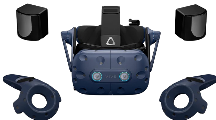
Figura 43: HTC Pro eye: componentes básicos
