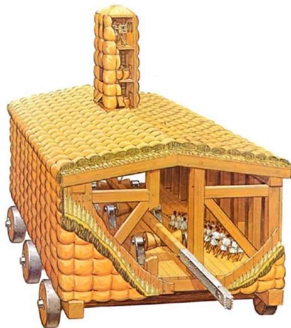
Fig. 8. Ariete tipo tortuga, Descrito por Vitruvio (10.13.6). Se desplaza sobre rodillos y tiene cabeza de metal.
