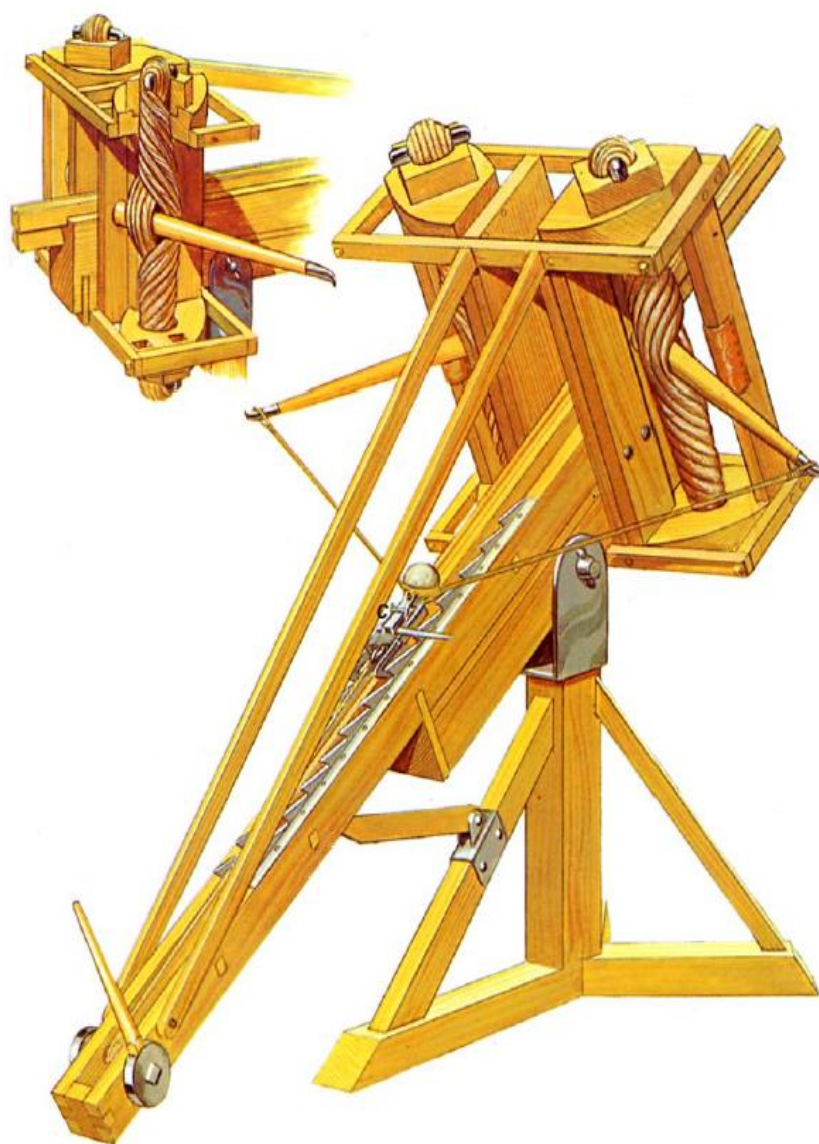
Fig. 11. Catapulta lanzadora de piedras ( καταπάλης λιθοβόλος ). A la izquierda, detalle del elemento elástico.
