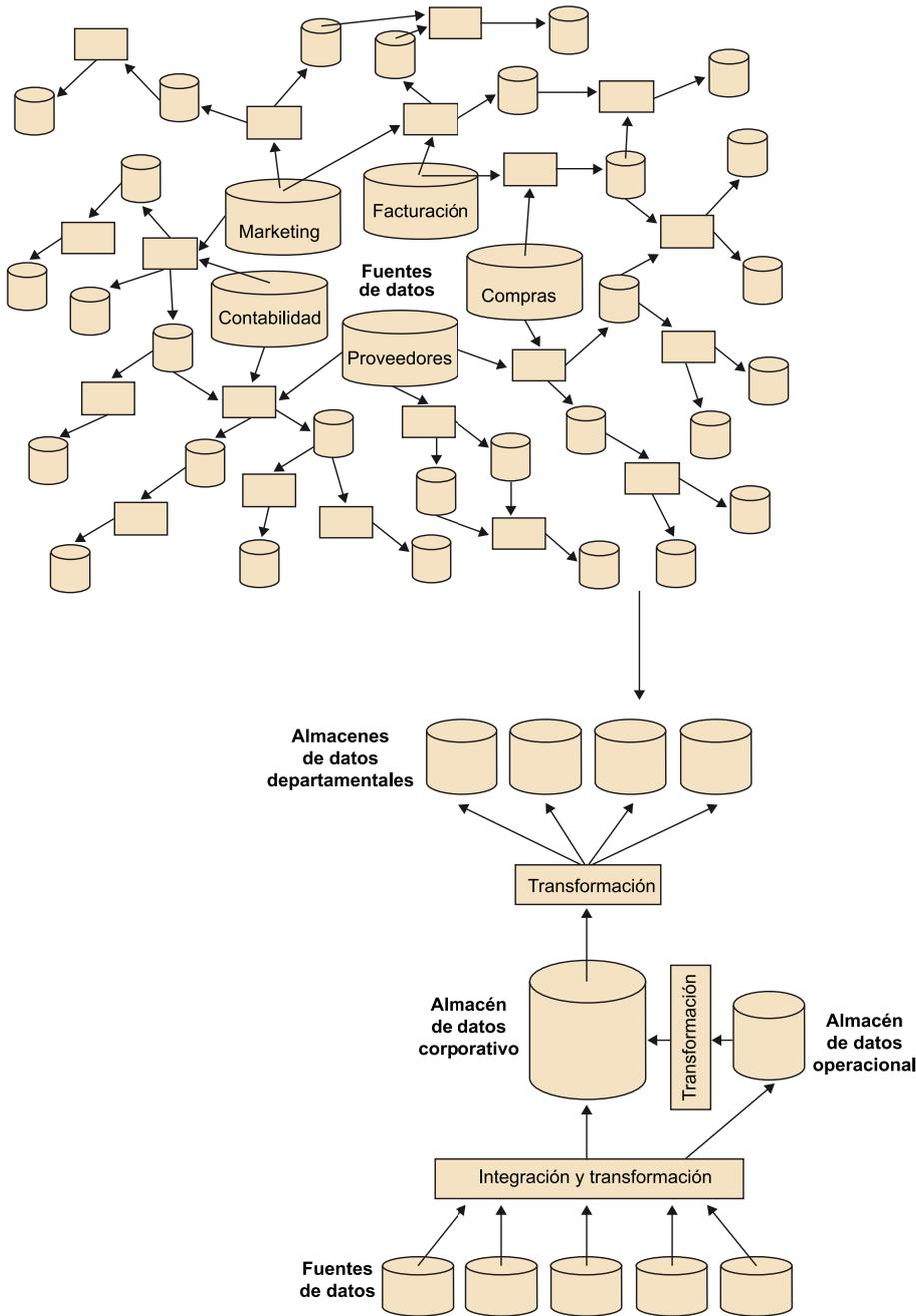
Podemos ver el resultado de desmantelar el entorno operacional en la figura 15. Pasamos de tener el entorno operacional de telaraña a tener la FIC, en la que las aplicaciones operacionales actúan como fuentes de datos y la extracción de los datos se hace de manera controlada y sistemática mediante el componente de integración y transformación.
