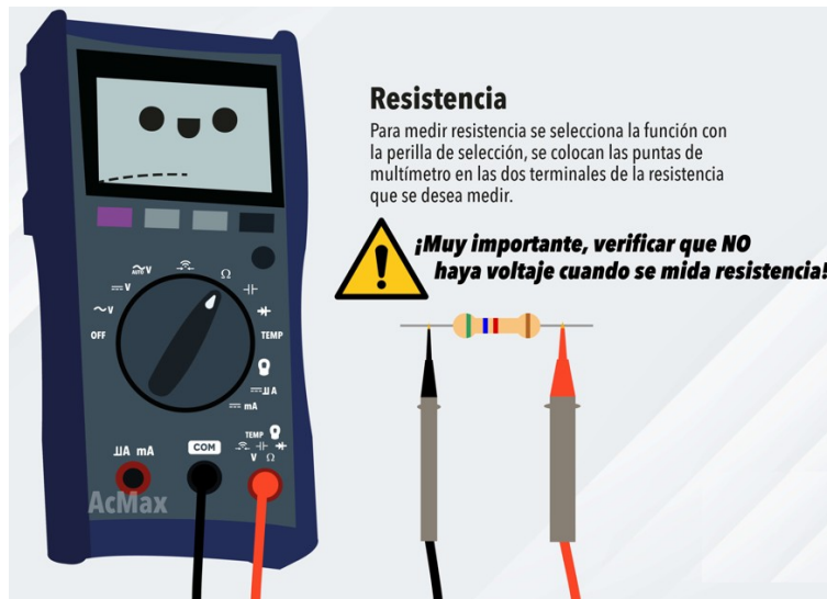
Figura 10. Medida de resistencia. Modificada de [11].
