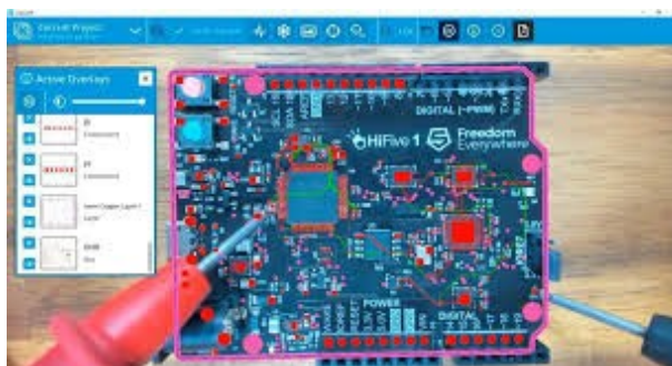
Figura 26. Imagen de una placa con RA superpuesta generada con InspectAR.
