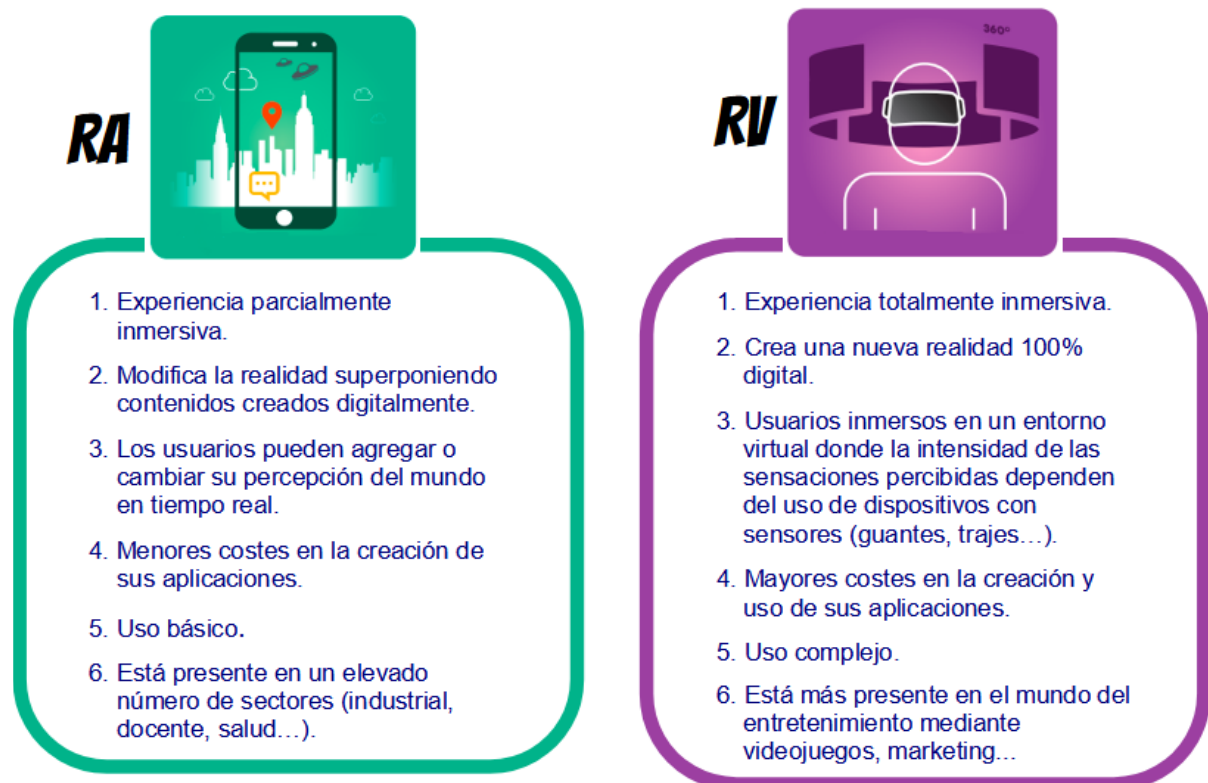
Figura 7. Comparativa entre RA y RV, adaptado de [32] .
