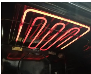
Figura 11. Resistencia superior de un horno encendido. Extraída de [4].
