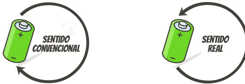
Figura 32. Sentido de la corriente eléctrica. Modificado de [23].
