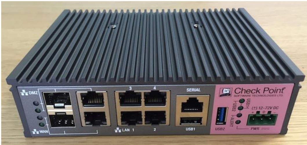
Ilustración 17: Firewall entornos industriales - Checkpoint modelo 1200R
