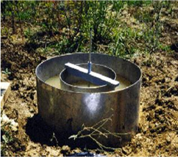
Figura 32. Infiltròmetre de doble anell
