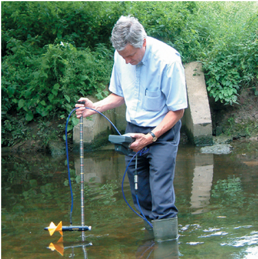
Figura 49. Mesura de la velocitat del flux amb un molinet amb nivells baixos d'aigua
