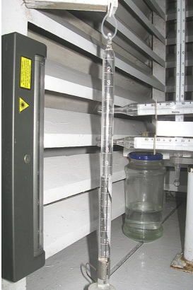
Figura 7. Evaporímetre de Piché graduat en mil·límetres i tancat a la part inferior per un disc de paper secant subjecte per un fleix metàl·lic
