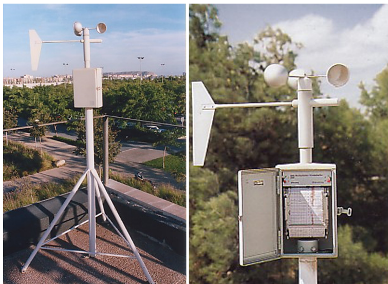
Figura 36. Detall de l'estructura d'un anemocinemògraf i de la seva banda de registre de la direcció i intensitat del flux
