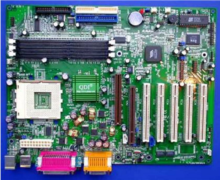
Figura 26. Exemple de placa amb ranures de DDR a la part superior esquerra (en negre)
