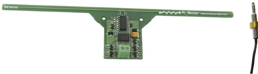
Figura 4. Tag RFID pasivo Pyros-0373 con sensor de temperatura
