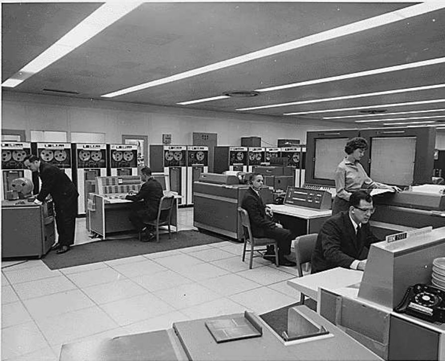
Figura 1. Típica sala de ordenadores, en este caso con dos IBM 7090 de finales de los años cincuenta.
