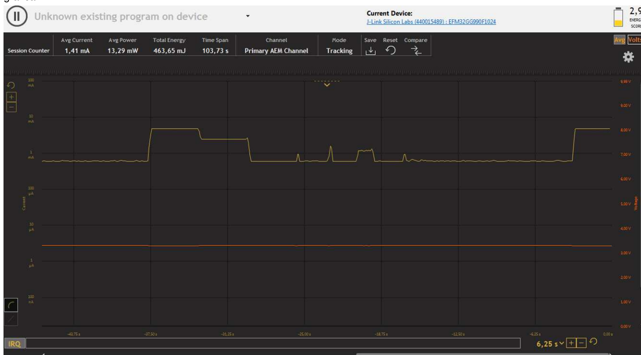
Figura 2. Medición de consumo. Se observan al menos tres modos de bajo consumo en la gráfica
