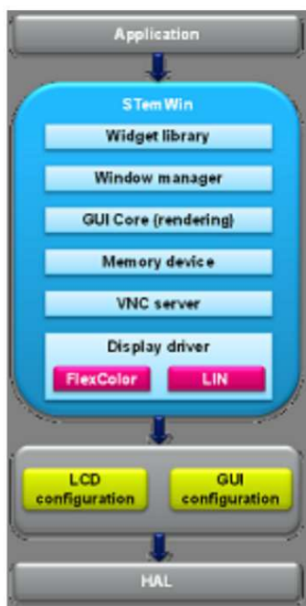
Figura 4. Diagrama de capas de la librería STemWin
