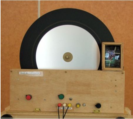
Model casolà de televisió mecànica. Es pot observar la imatge a la petita pantalla de la dreta. Font: User:G1MFG - Own work. Domini públic. https://commons.wikimedia.org/w/index.php?curid=18009704
