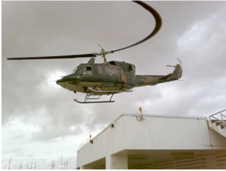
Exemple de distorsió per l'escaneig seqüencial. Les aspes de l'helicòpter es mostren distorsionades a causa del seu moviment, més ràpid que l'escaneig del sensor. Font: Paul_012 - Treball propi, CC BY-SA 3.0, https://commons.wikimedia.org/w/index.php?curid=15933692
