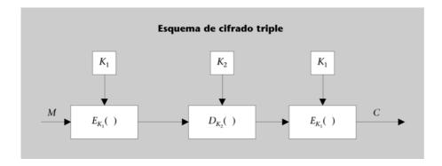
Cada caja representa el cifrador de bloque. El cifrador aplica a ambos extremos del mensaje la función de cifrado con la clave  $E_{K_1}$ , mientras que en la caja de en medio se aplica la función de descifrado  $D_{K_2}$ . Las ecuaciones correspondientes son:
