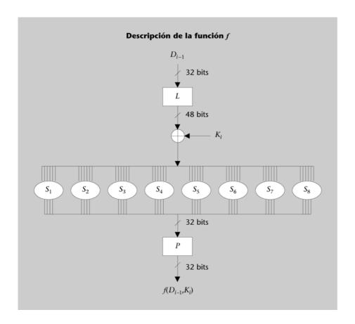
En primer lugar se transforma  $D_{i-1}$  para que tenga una longitud de 48 bits\*. Para extender  $D_{i-1}$  se han repetido algunos de sus bits por medio de la transformación de expansión, L, que queda determinada en la tabla siguiente:
