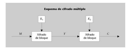
Esta técnica de cifrado múltiple requiere la utilización de un criptosistema –como el DES– que no forme un grupo algebraico. Esta última condición es necesaria porque si la función de cifrado formara un grupo algebraico, la operación de cifrar un mensaje con una clave  $K_1$  y volver a cifrar el resultado con otra clave  $K_2$  sería la misma que cifrar el mensaje sólo una sola vez con una tercera clave  $K_3$ .
