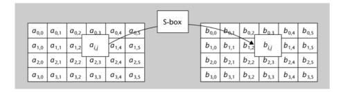
Más concretamente, la tabla de sustitución *S*, que actúa para cada bit de la matriz de estado, es invertible y se compone de dos transformaciones:
