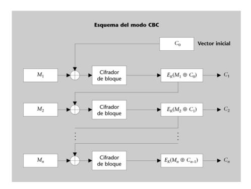
Supongamos un cifrado en bloque con una clave K, una función de cifrado E y una de descifrado D. Si  $M_1$ , ...,  $M_n$  son los bloques de texto en claro por cifrar con el sistema CBC, el cifrado del bloque  $M_i$  se lleva a cabo de la manera siguiente:
