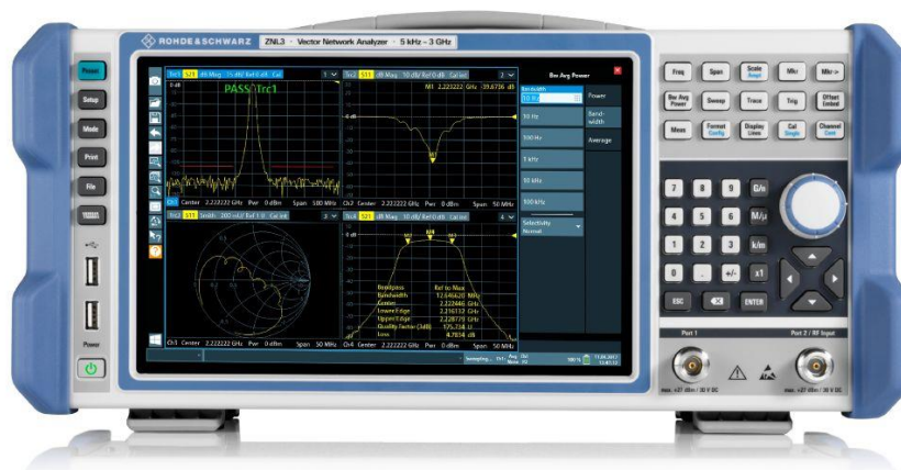
Ilustración 64 Analizador de Espectros Rhode Schwarz ZNL3
