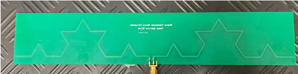
Ilustración 63 Antena fractal tras el proceso de soldadura
