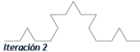
Ilustración 42 Fractal seleccionado para el diseño de la antena
