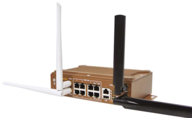
Ilustración 29: Switch PoE wireless routing LPWAN
