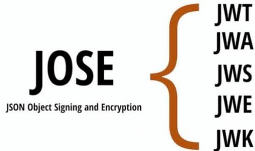
Ilustración 3. Componentes del conjunto JOSE (JSON Object Signing and Encryption)
