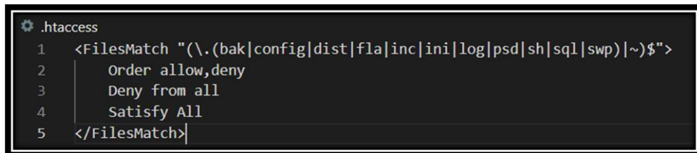
Figura 22: Código HTML para evitar la brecha de seguridad mostrada en la Figura 20.
