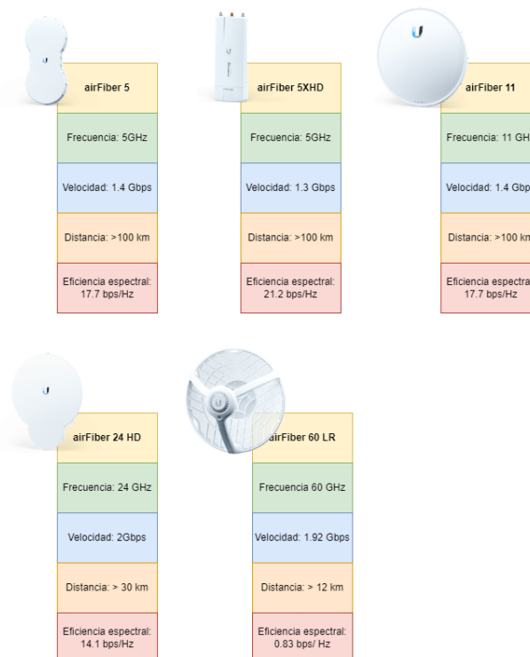
Ilustración 19: Equipos radioenlace Ubiquiti
