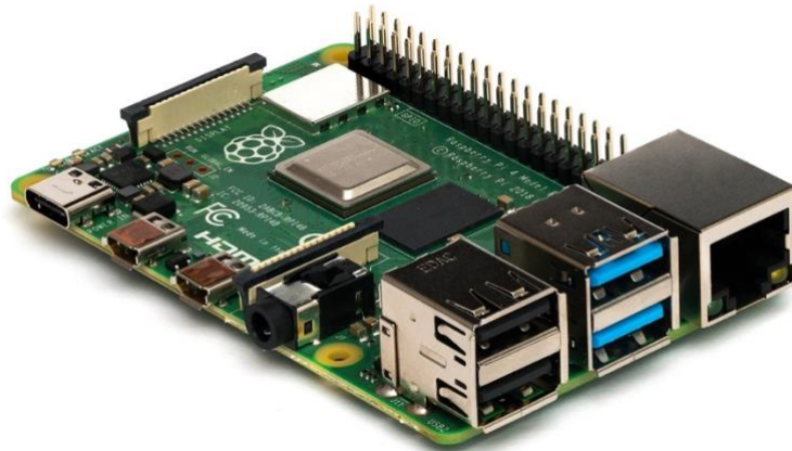
Il·lustració 13 - Placa de la Raspberry Pi 4 utilitzada durant el projecte. Extret de [4]
