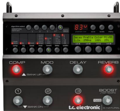
Il·lustració 7 - Multiefectes comercial de la marca TC Electronics per guitarra. Extret de [49]
