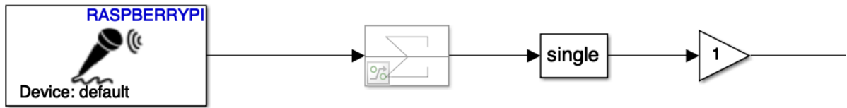
Il·lustració 19 - Diagrama de blocs del sistema de captació del projecte
