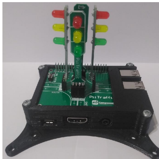
Ilustración 18: PiTraffic totalmente montado en la RPi
