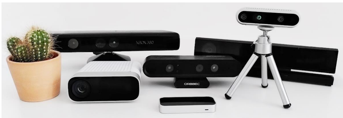
Il·lustració 8: comparança visual entre diferents càmeres de profunditat: se'n destaca la Kinect 1 (darrere a l'esquerra), la Kinect 2 (darrere a la dreta), l'Intel RealSense D435 (davant a la dreta en el trípod) i l'Azure Kinect (davant a l'esquerra al costat del cactus) 7
