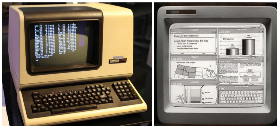
Il·lustració 4: CLI en terminal de vídeo DEC VT100 2 (esquerra) i GUI en Xerox Star 8010 3 (dreta)
