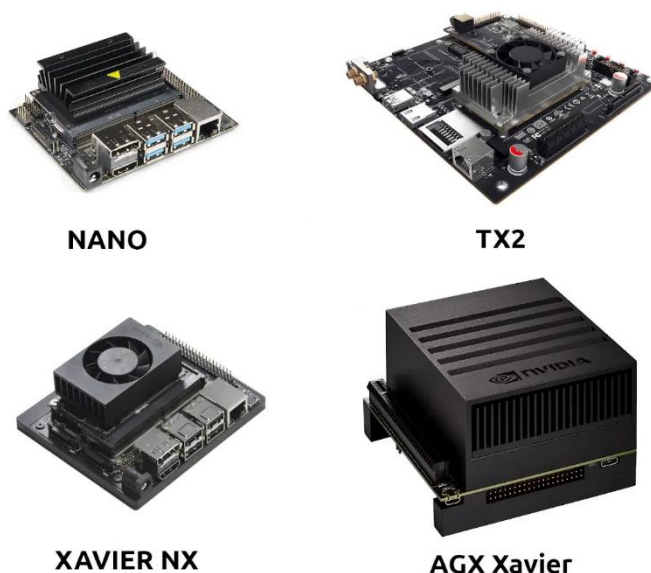
Il·lustració 12: mòduls de la gamma NVIDIA Jetson: Nano, TX2, Xavier NX i AGX Xavier 11
