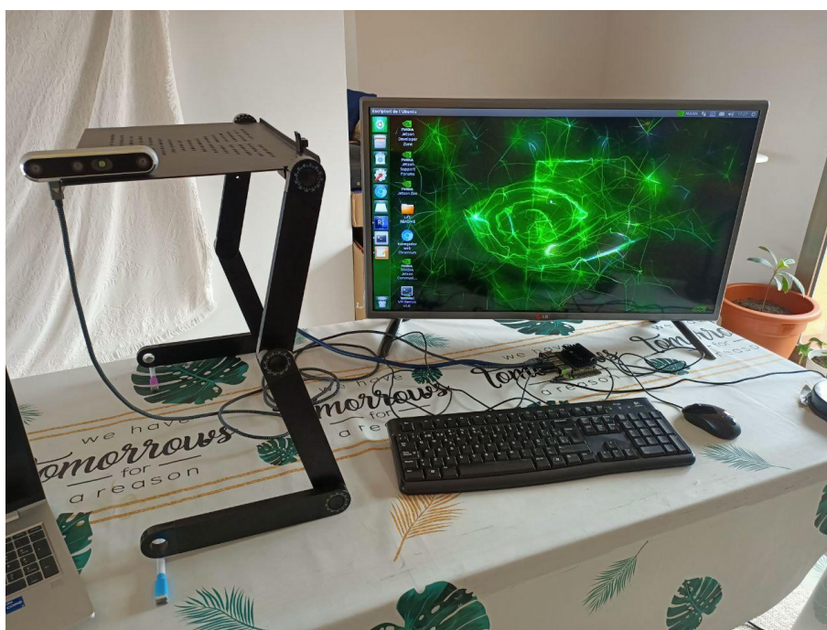
Il·lustració 14: muntatge necessari per a la gravació de gestos (mòdul de desenvolupament NVIDIA Jetson Nano, monitor HDMI, teclat i ratolí USB i càmera Intel RealSense D455 USB 3.0 en suport elevat)
