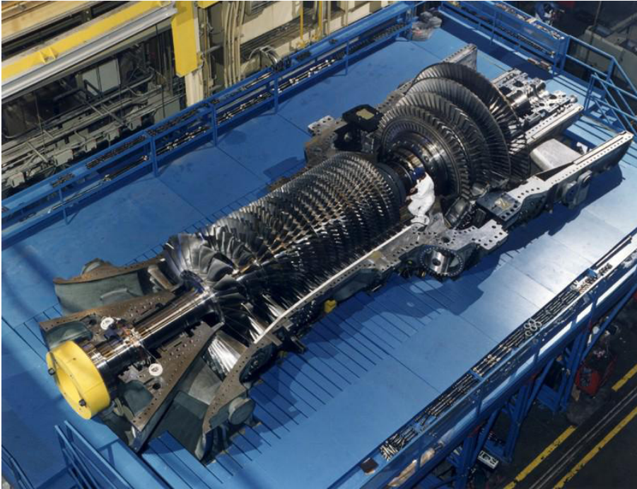
Figura 17. Turbina de gas
