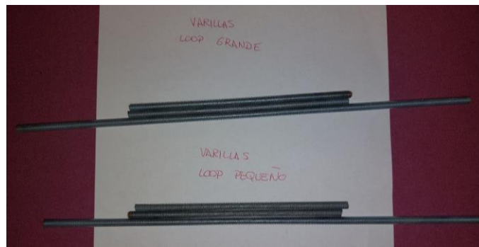
Figura 41. Varillas roscadas cortadas a su medida
