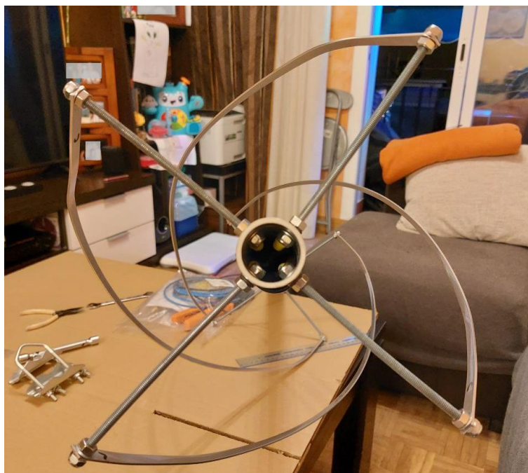
Figura 45. Pletinas giradas a izquierdas para obtener RHCP
