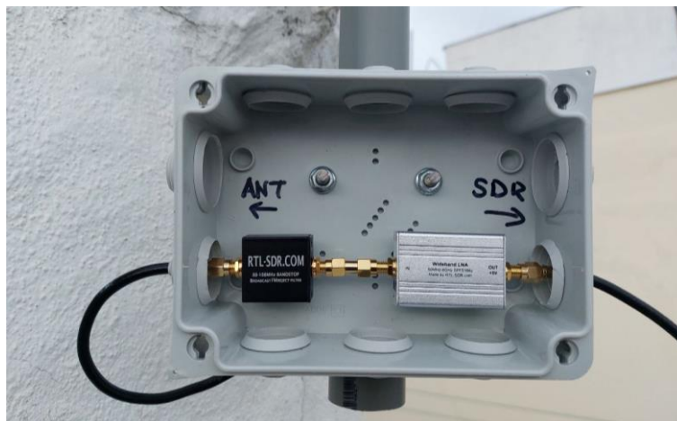
Figura 61. Caja estanca con Filtro FM + LNA
