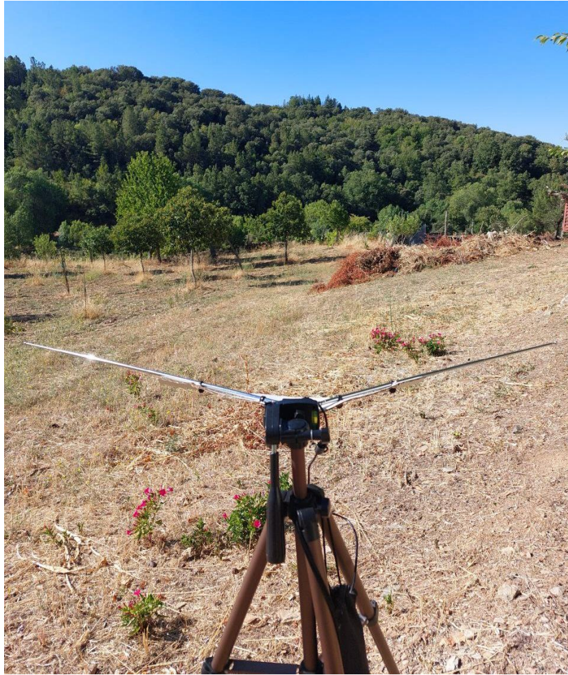
Figura 53. Instalación de la antena dipolo en un trípode fotográfico
