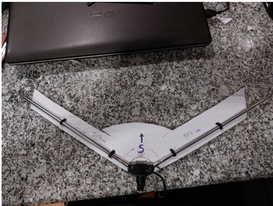
Figura 52. Antena dipolo fijada a 120°
