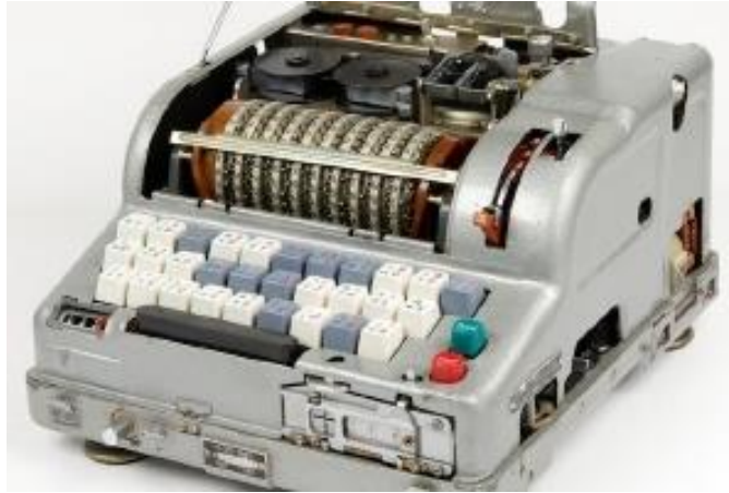
Figura 48. Fialka M-125 [42] con el detalle de los rotores
