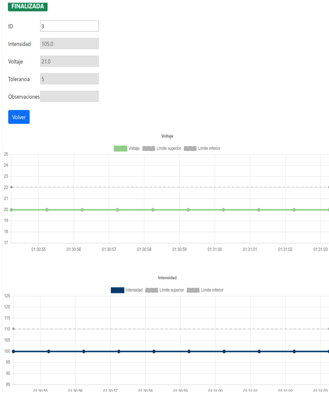
Ilustración 43: Gráficos de soldadura terminada
