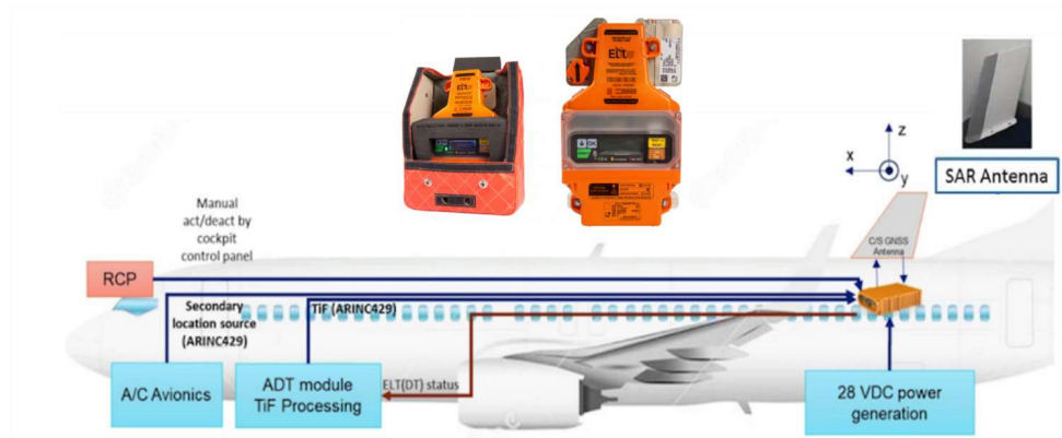
Figura 39: Integración de antena ELT(DT) en avión comercial
