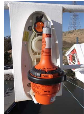
Figura 37: EPIRB con activación hidrostática
