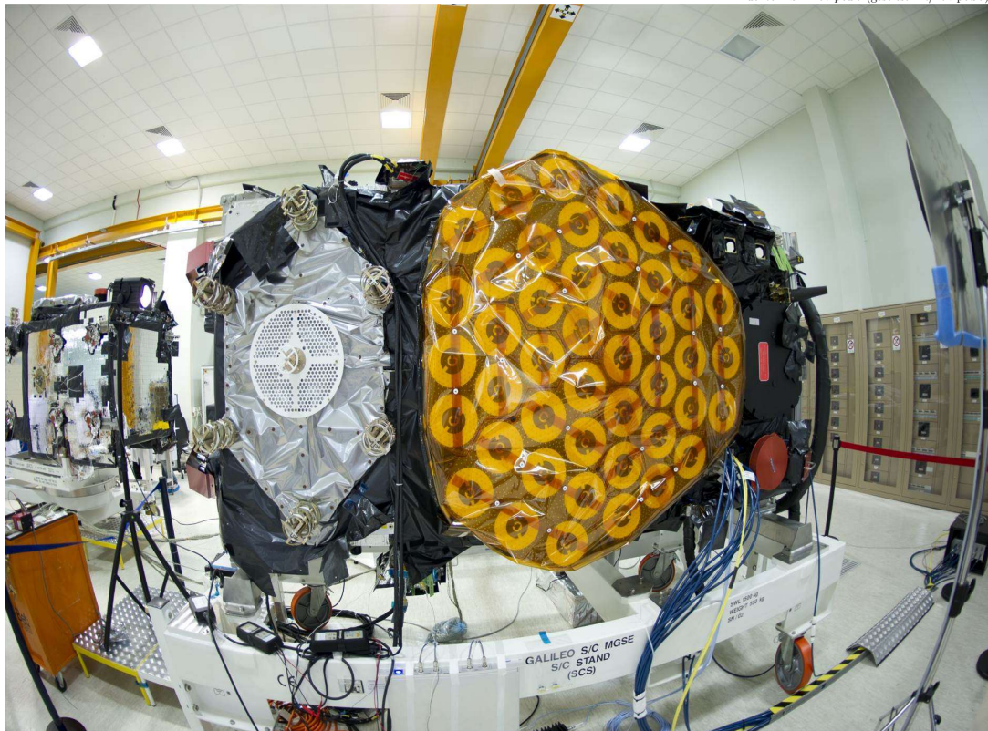
Figura 10: Estructura de antenas en satélite IOV de Galileo
