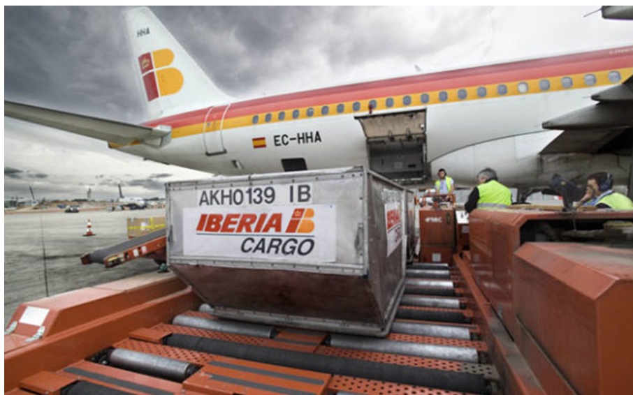
Figura 5. Procés de càrrega d'un contenidor aeri en un avió de càrrega de la companyia Iberia.
