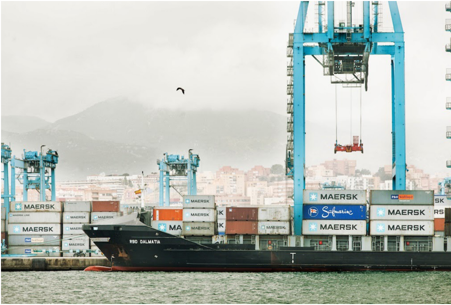
Figura 1. Operacions de càrrega i descàrrega d'un vaixell portacontenidors al port d'Algesires per una grua de moll dirigida per un estibador.
