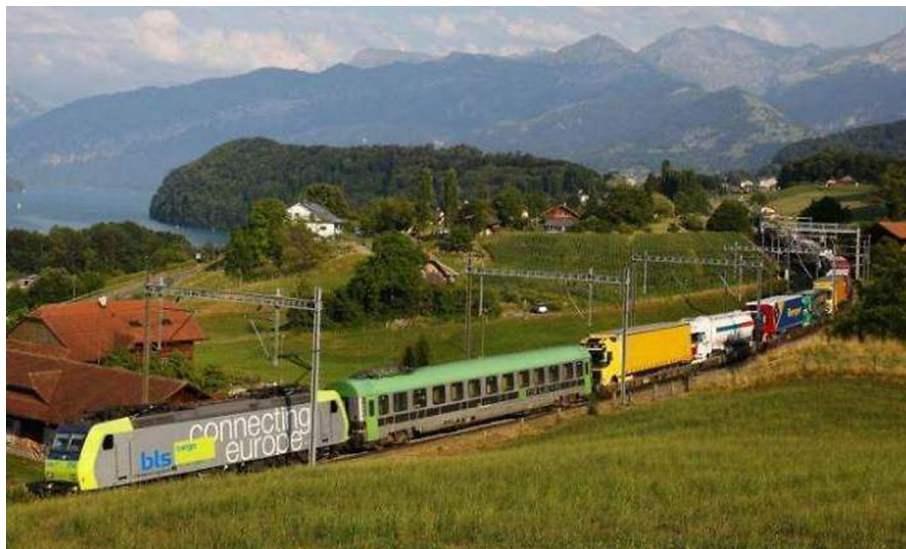
Figura 9. Autopista ferroviària al centre d'Europa (Suïssa) amb vagons extra baixos (sistema ROLA).
