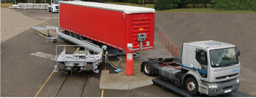
Figura 10. Sistema LOHR dissenyat especialment per a carregar els semiremolcs estàndards.
