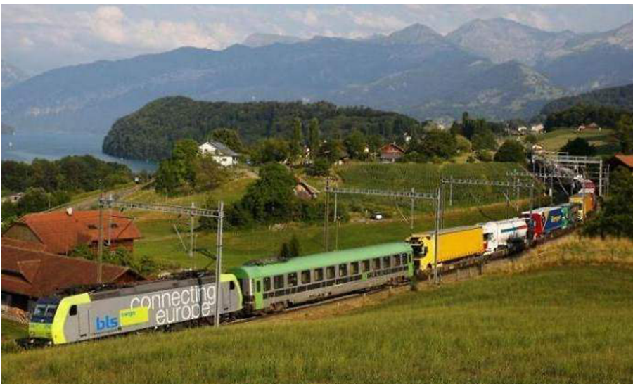
Figura 9. Autopista ferroviaria en el centro de Europa (Suiza) con vagones extrabajos (sistema RÖLA)
