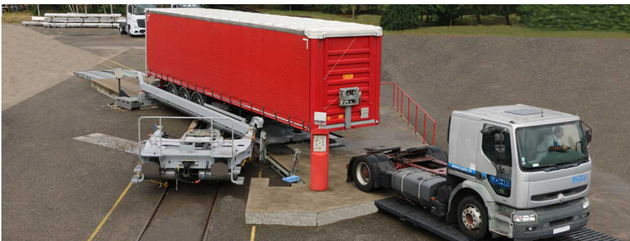
Figura 10. Sistema LOHR diseñado especialmente para la carga de los semirremolques estándar
