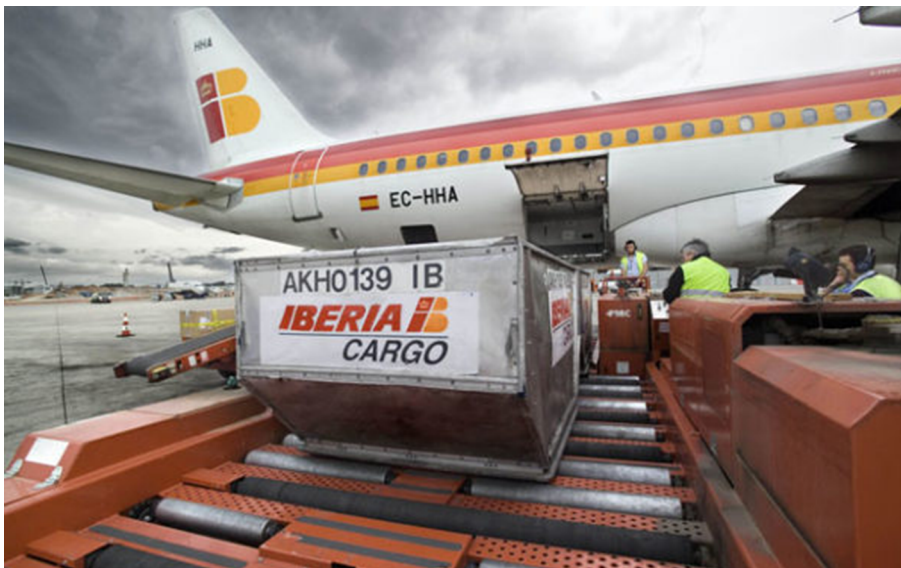
Figura 5. Proceso de carga de un contenedor aéreo en un avión de carga de la compañía Iberia
