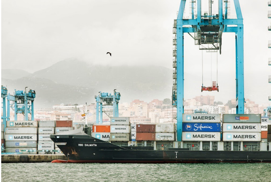
Figura 1. Operaciones de carga/descarga de un buque portacontenedores en el puerto de Algeciras por una grúa de muelle dirigida por un estibador
