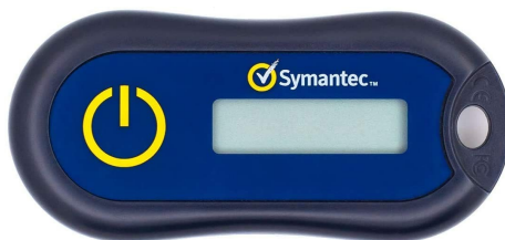
Figura 3: Dispositivo físico de generación de código de un solo uso.
