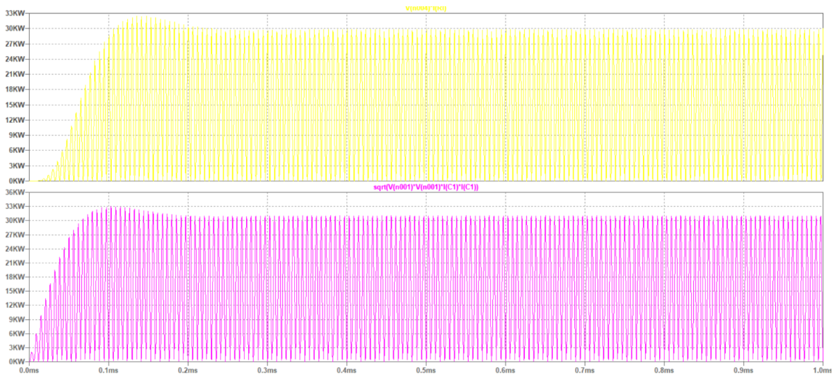
Figura 55: Comparativa de la potencia entregada por el inversor (señal de color rojo) y la entregada a la carga (señal de color verde)
