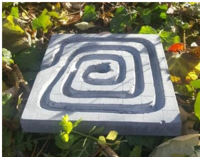
Figura 30: Molde para fabricación de piezas de Magment [47].
