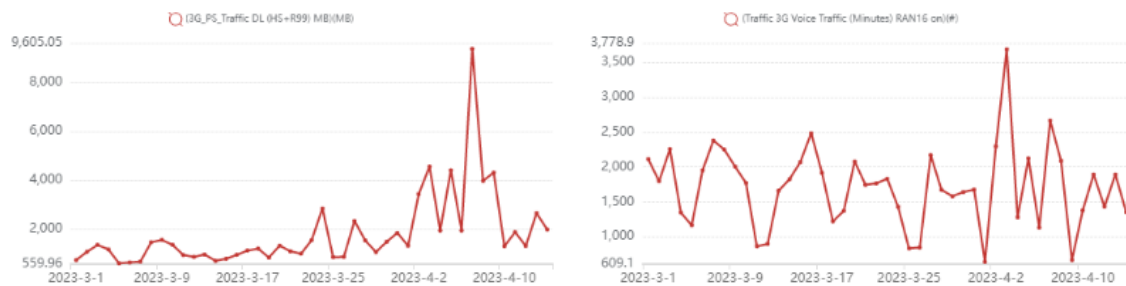
Figura 28. Tráfico de datos y voz 3G del nodo del nodo impactado por el evento
