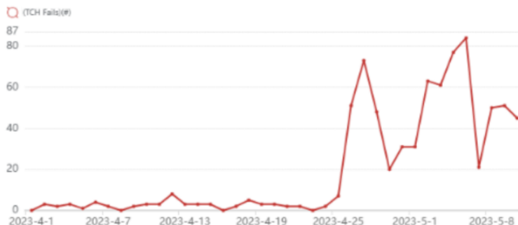
Figura 66. Fallos de la celda 2G del nodo con ajuste de parametrización de CSFB
