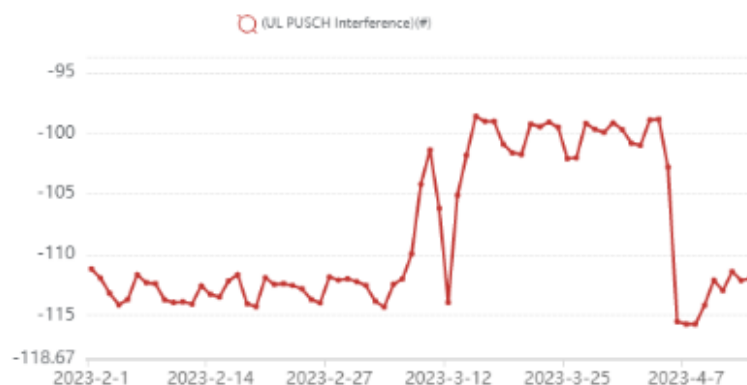
Figura 37. RSSI de nodo con afectación de RSSI
