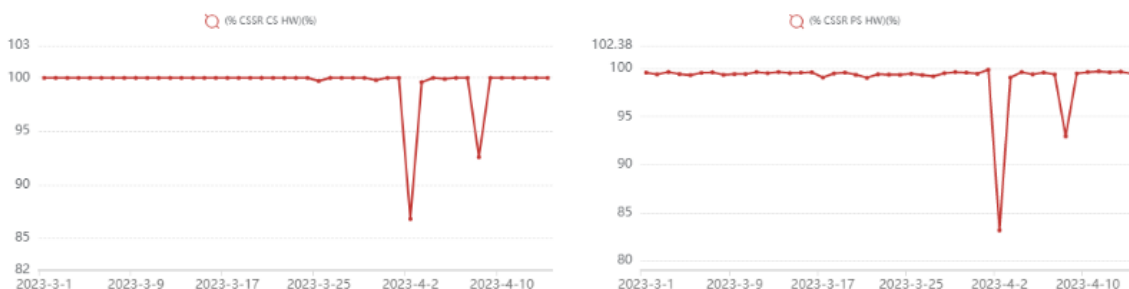
Figura 29. Accesibilidad de voz (CS) y de datos (PS) 3G del nodo del nodo impactado por el evento
