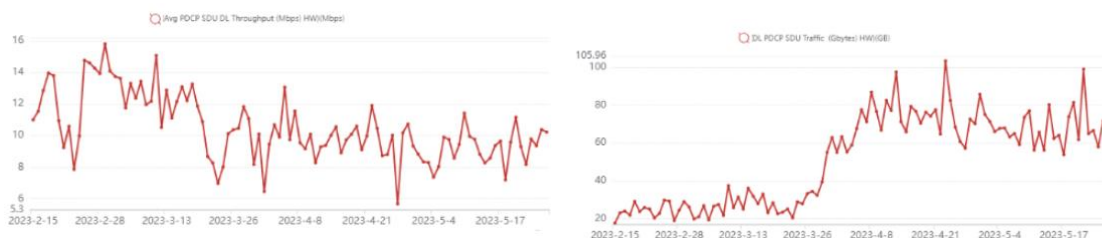
Figura 63. Throughput y tráfico de celda con aumento de potencia
