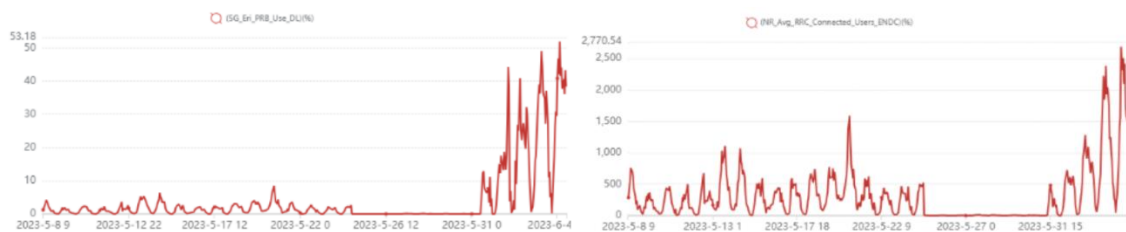
Figura 72. Uso de PRBs y usuarios conectados en celda 5G afectada
