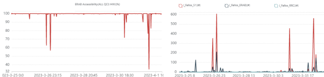
Figura 22. Accesibilidad y fallos del nodo afectado
