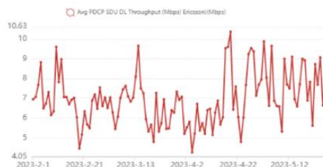
Figura 56. Throughput de la celda con cambio de tilt
