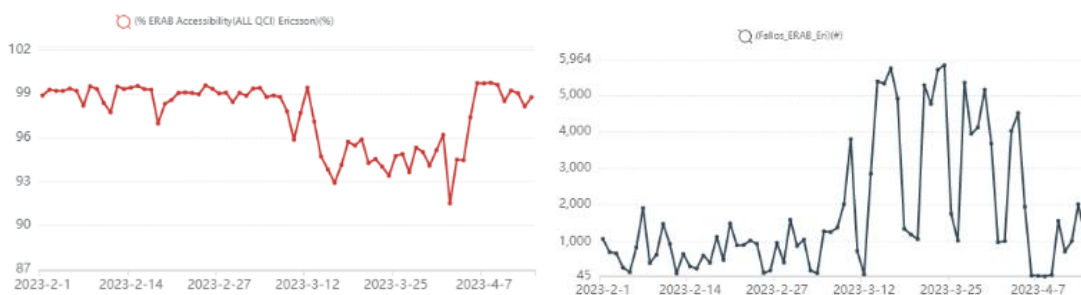
Figura 39. Accesibilidad y fallos de nodo con afectación de RSSI
