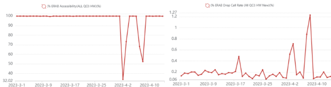
Figura 33. Accesibilidad y Drop Call Rate 4G del nodo del nodo impactado por el evento
