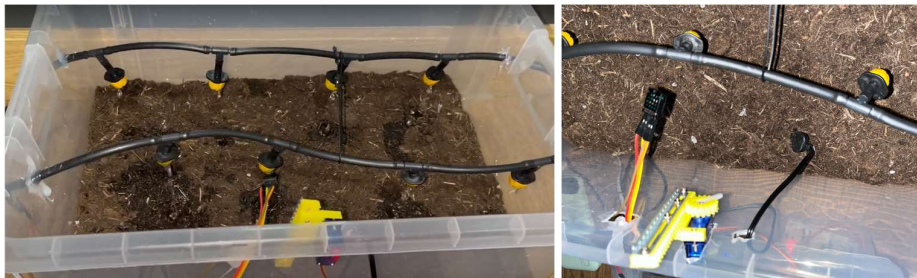
Figura 53. Detalle sistema regando por goteo y sensores en semillero
