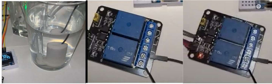
Bomba sumergida Relé sin pin de entrada Relé con pin de entrada
