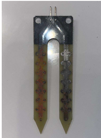
Figura 16. Oxidación en electrodos de sensor YL-69
