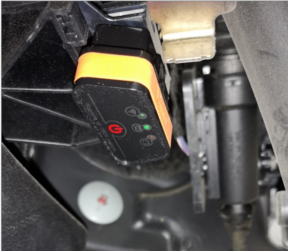
Ilustración 39. Adaptador ELM327 enchufado al conector OBD-II
