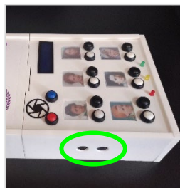
Figura 24: Sensor ultrasonidos proyecto
