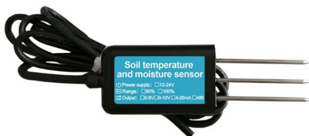
Figura 18. Sensor de temperatura y humedad utilizado.
