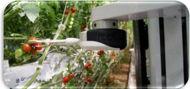
FIGURA 38: ROBOT CON SISTEMA DE DETECCIÓN DE MADURACION DEL TOMATE[94]
