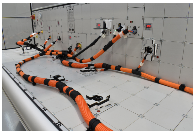
Imatge d'inserció de tots els components del cable a les contrapeces.
