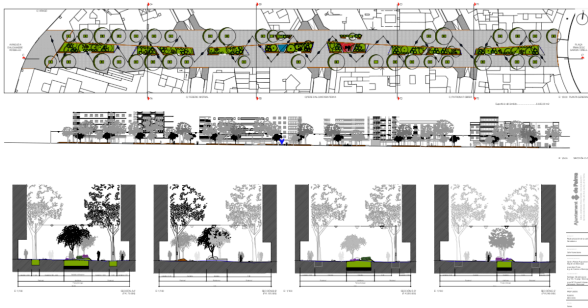
Fig. 5 Detall del projecte de reurbanització. Secció del carrer i disposició de les zones ajardinades (Font: Aj. de Palma)
