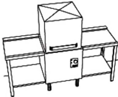
Composició de rentaplats de capota amb una producció teòrica de 800 plats/hora
