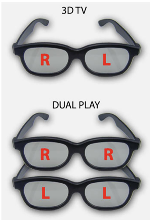
Figura 22. Ulleres 3D complementàries
