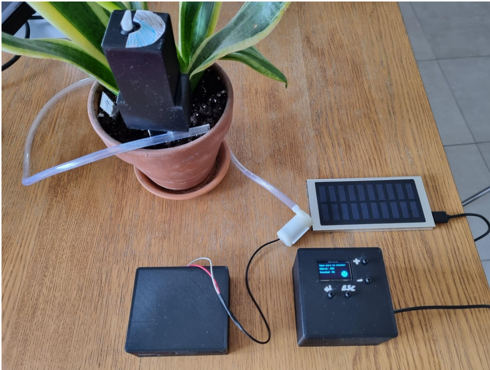
Figura 32: sistema automático de riego.
