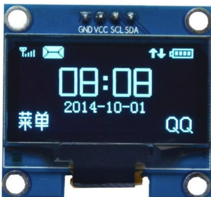
Figura 10: pantalla OLED LCD de 1.3 pulgadas.
