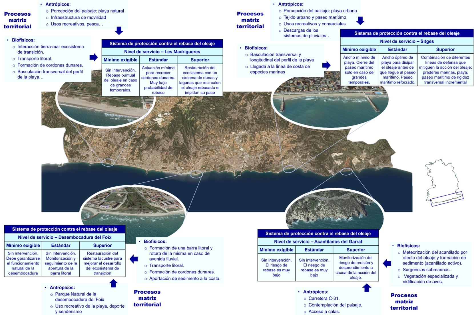
Figura 4. Ejemplo de aplicación del “catálogo de soluciones” para el caso de la infraestructura de protección contra el rebase del oleaje. Fuente: propia sobre ortofoto del Instituto Cartográfico y Geológico de Cataluña (ICGC, 2022) e imágenes importadas desde Google Earth (SIO et al., 2022).
