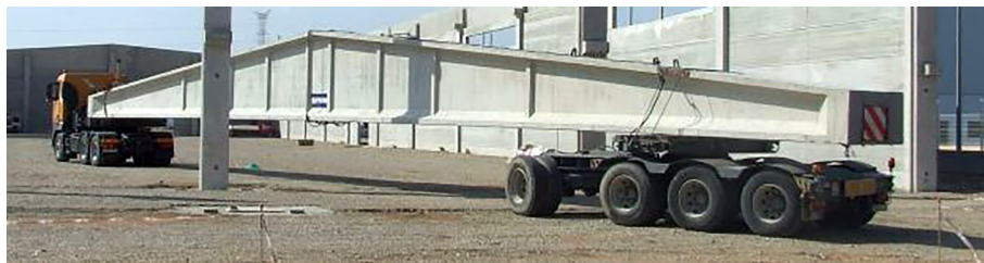
Figura 3. Exemple d'un camió Dolly per a transportar una biga de formigó prefabricada
