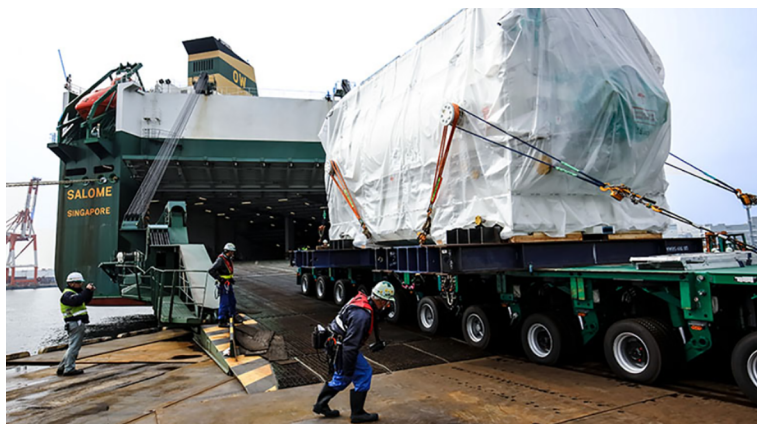
Figura 6. Project cargo transportada en vaixell de càrrega rodada
