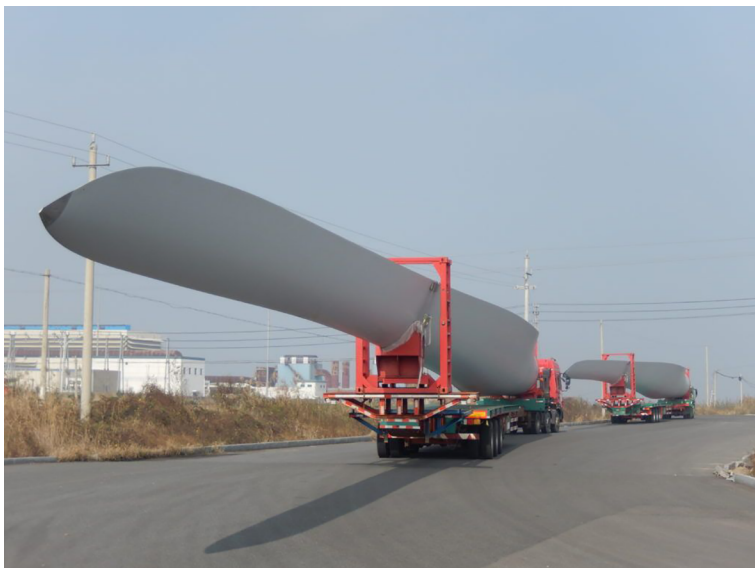
Figura 14. Transport per carretera de les pales dels aerogeneradors
