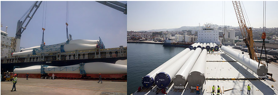
Figura 12. Transport marítim i operacions portuàries de càrrega i descarrega de pales eòliques i trams de torre d'aerogeneradors
