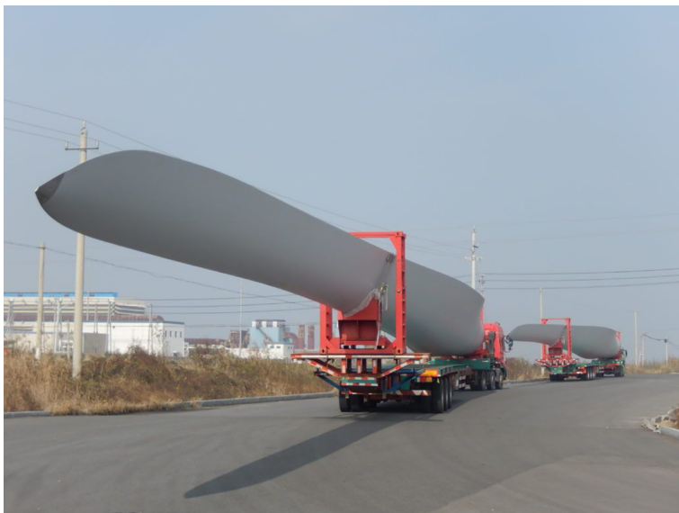
Figura 14. Transporte por carretera de las palas de los aerogeneradores
