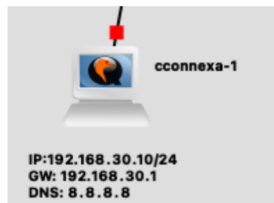
Figura 10.3-7 Conector Cloud Connexa desplegado en GNS3
